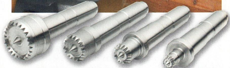
Diese Mehrzahn-Antriebsspitzen sind von Zähnen umrandet. Der zentrale Antriebspunkt ermöglicht eine genaue Positionierung. Das Design garantiert einen extrem starken Grip, dank der vielen Kontaktpunkte im Holz, wodurch auch das Risiko, das Holz zu spalten, minimiert wird.
