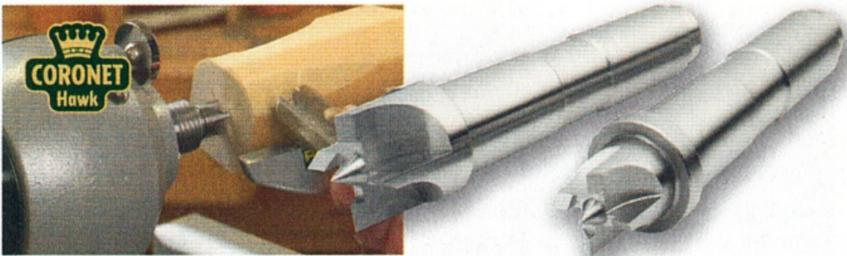
Die traditionelle 4-Zack-Antriebsspitze ist so konstruiert, dass sie dem Holz durch das Prinzip der gegenläufigen Zahnprofile einen festen Halt gibt. Die zentrale Spitze des Werkzeugs fixiert die Antriebsspitze, die vier umliegenden Zähne halten das Holz sicher fest und das gegenläufige Zahnmuster sorgt dafür, dass die Holzfasern zusammengezogen werden, um die Gefahr des Spaltens zu verringern.
